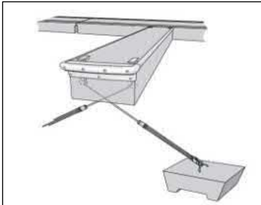
Kuva 3-5: Esimerkki kelluvasta kulkutiestä laituripaikkojen välissä (Lähde: Marinetek).
