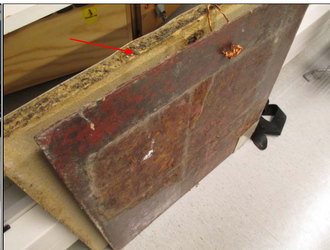
Lastulevyssä kosteuden aiheuttamaa turpoamista
