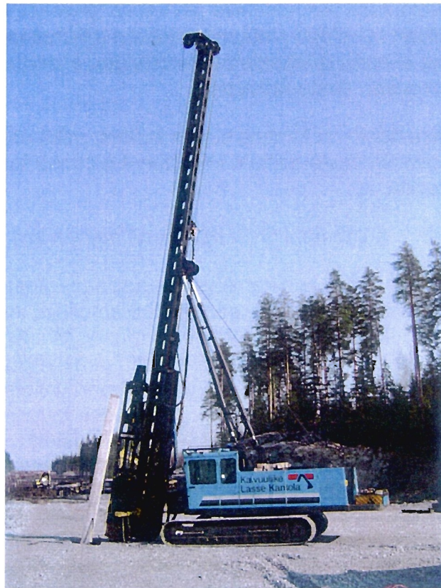
Kuva 2-8 Junttan HHK-A sarjan hydraulisen järkäleen rakenne ja paalutuskonerunko PM20 varustettuna Junttan HHK-4A järkäleellä.
