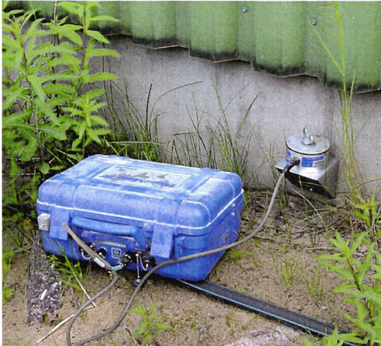
Kuva 5.8 Tärinämittari kiinnitettynä rakennuksen perusmuuriin
