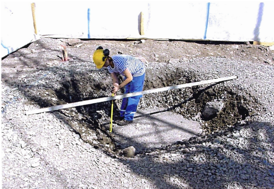
Kuva 5.10 Pudotuksesta syntyneen kuopan syvyysmittaus
