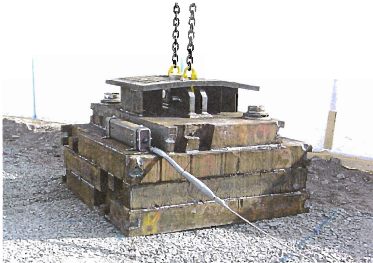
Kuva 5.3 200 kN pudotusjärke ja järkeeseen kiinnitetty PDA-mittausanturi (RHS-palkki, josta lähtee kaapeli)
