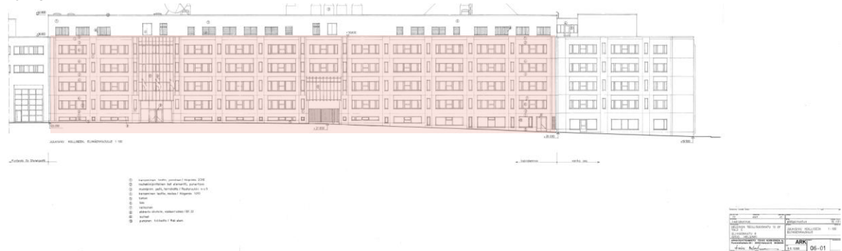
Kuva 3.13. Kopio Elimäenkadun puoleisesta julkisivupiirustuksesta, jossa purettavan Elimäenkadun rakennusosa korostettu punaisella (Arkkitehtitoimisto Toivo Korhonen ky, 1988)
