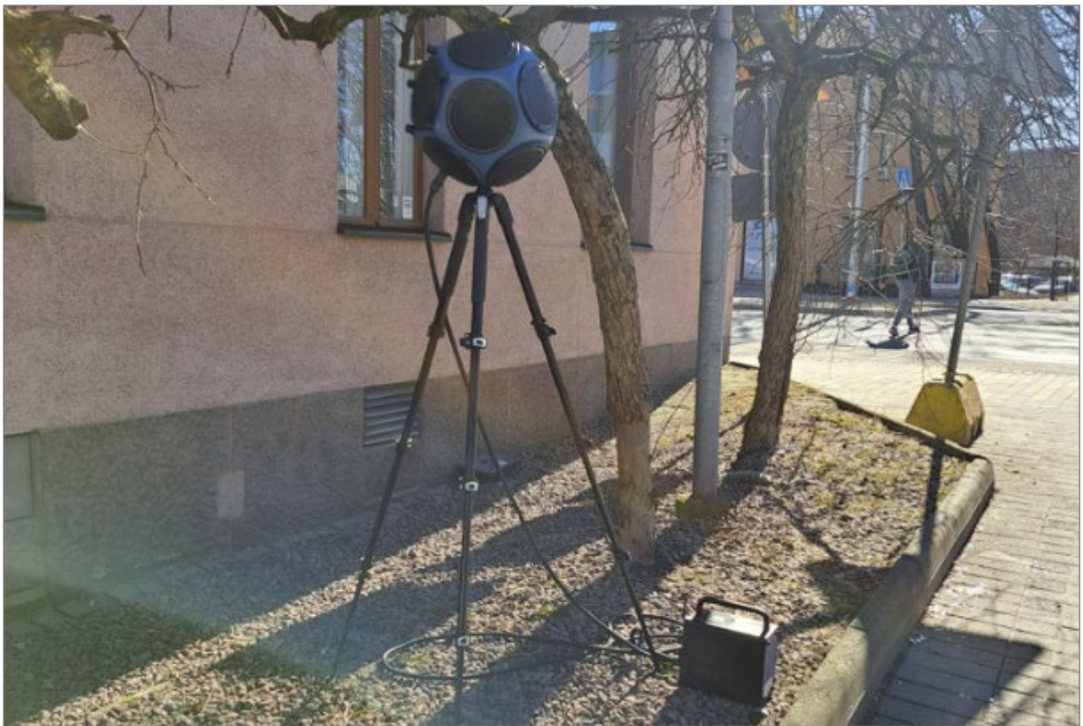
Kuva 2. Kuva ulkopuolella sijaitsevasta äänilähteestä.
