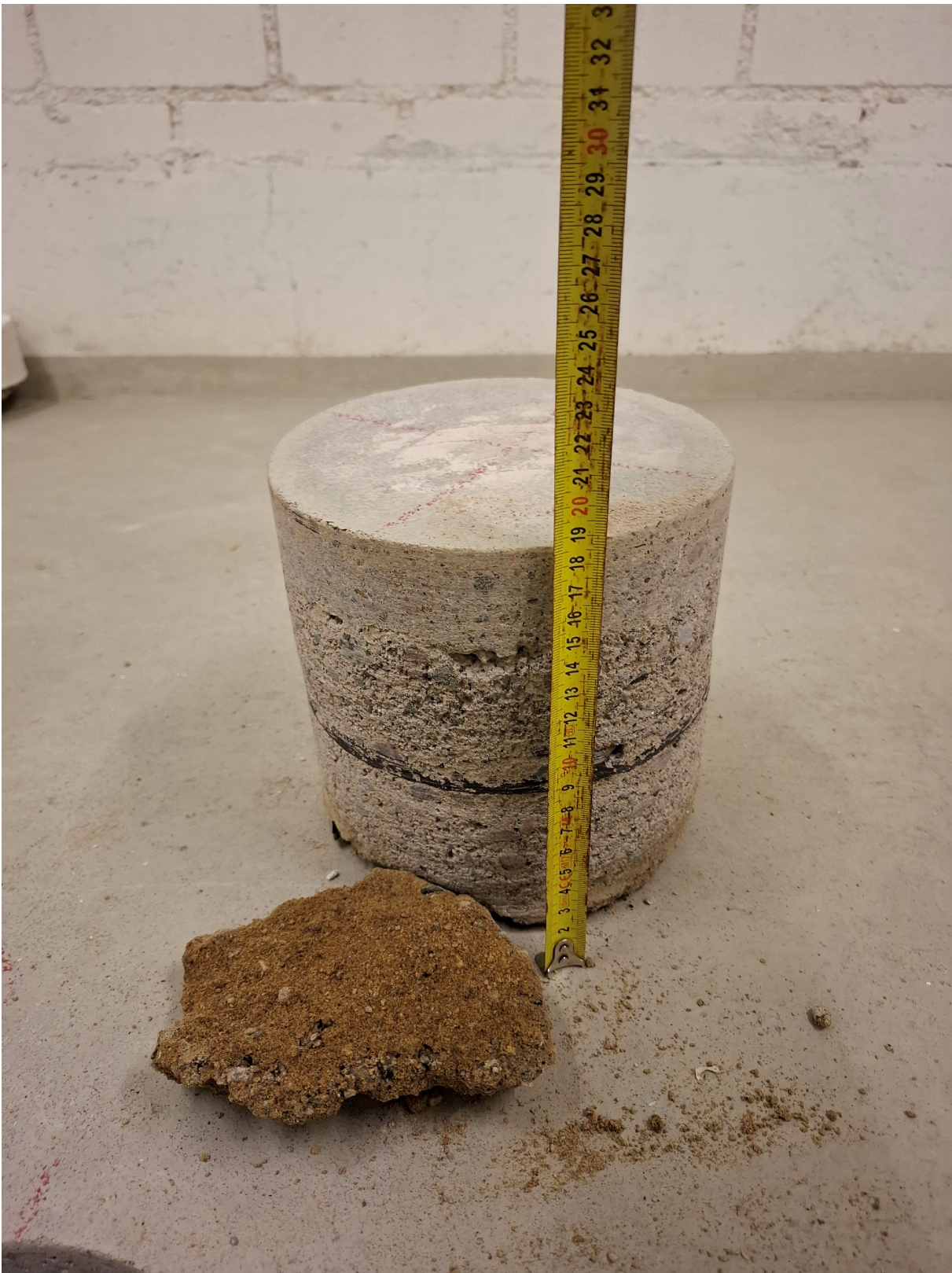
Kuva 8. Näytepiste SE9. Tässä osassa rakennusta routamattoa ei havaittu betonilaatan alla. Betonin paksuus hieman muita läpäisyjä paksumpi tässä näytepisteessä.
