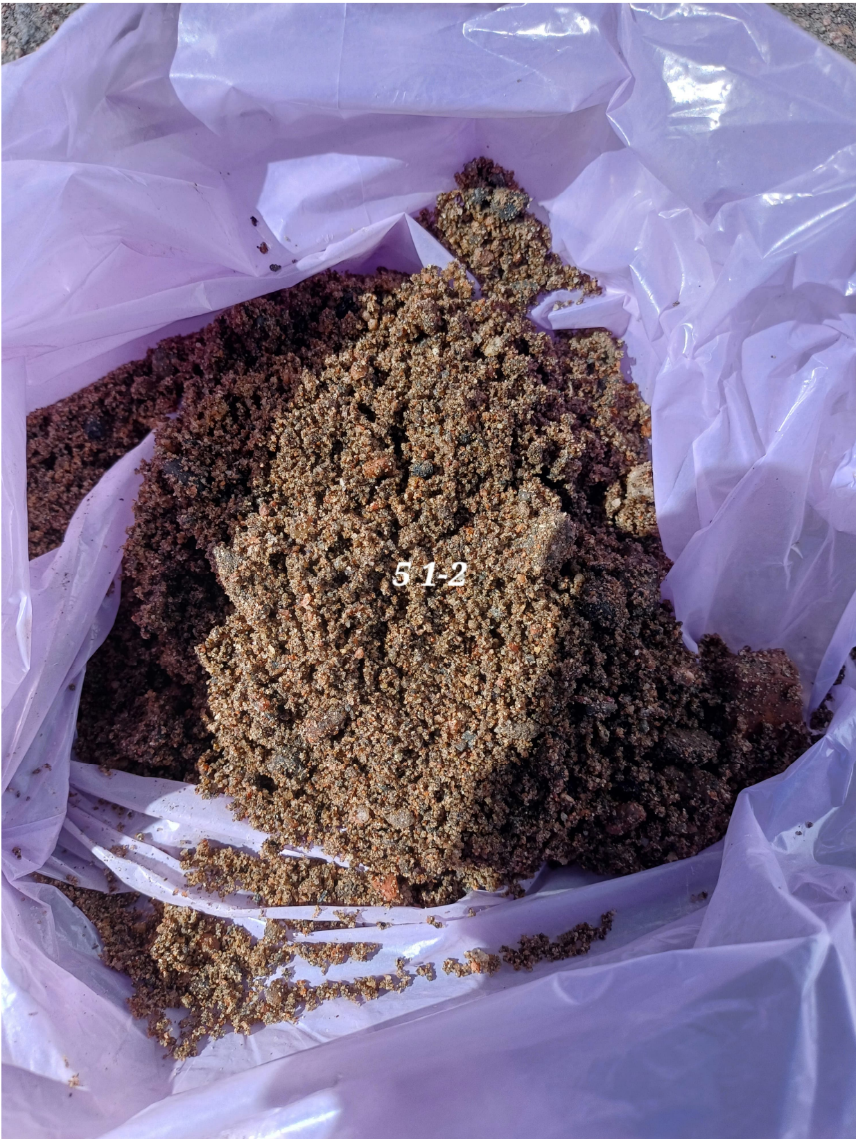
Kuva 4. Tutkimuspiste SE5/1,0–2,0 m. Täyttömaata, joka koostui valtaosin hiekasta. Seassa vähäinen määrä myös kiveä. Tässä näytepisteessä havaittiin pieni määrä tiiltä hiekan seassa.
