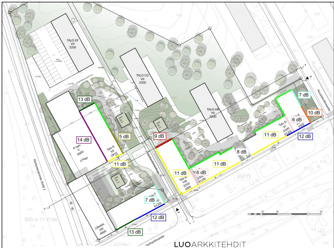
Kuva 3. Lasitettujen parvekkeiden suositukset äänitasoero-vaatimuksiksi \Delta L_{A,vaad} . Vihreällä on esitetty julkisivuilla sijaitsevat parvekkeet, jotka suositellaan lasitettavaksi, mutta niiden meluntorjuntaa ei ole tarpeen erikseen mitoittaa.
