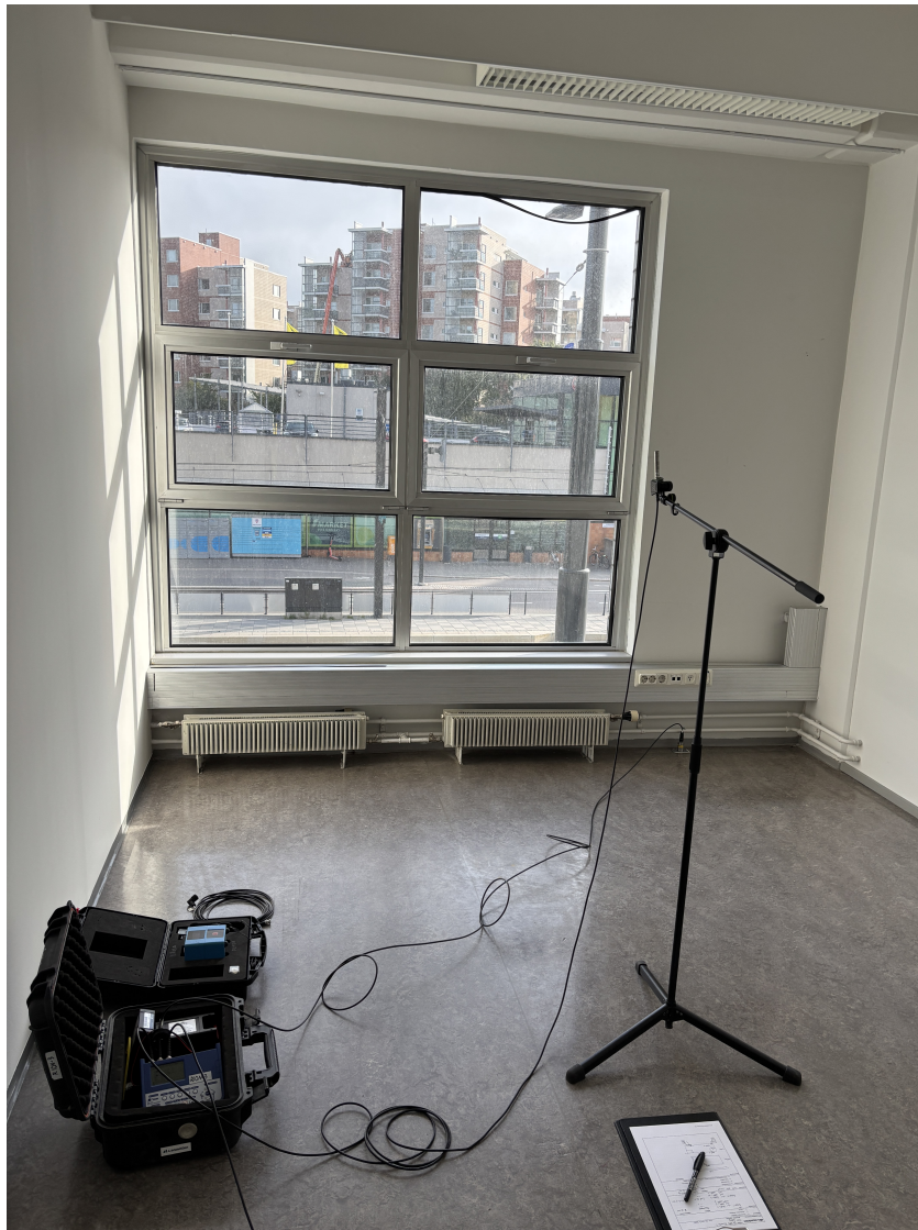
Kuva 3: 2.krs mittauspisteet toimistohuoneessa (R4 ja R5). R6 asennettiin viereisessä huoneessa samalla tavalla kuin R5.
