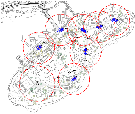
Kaavio rakentamisen aikaisista nostopaikoista.
