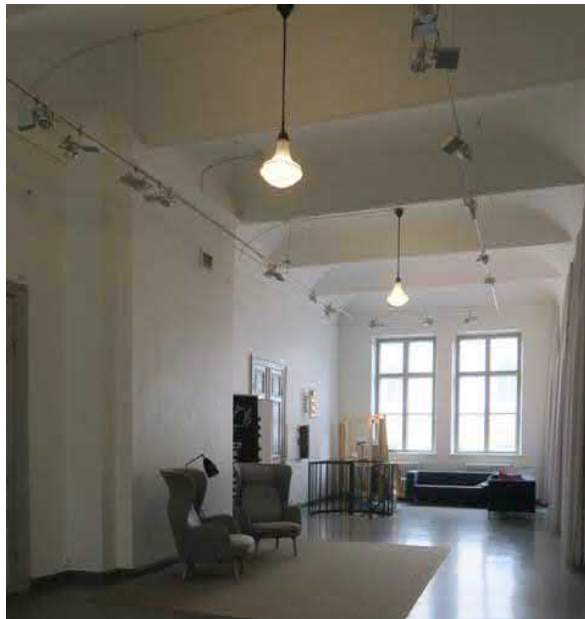
Yläkuva 3/2004, oikealla 3/2024. 3. kerroksen käytävä. 1- ja 2-kerroksen käytävistä poiketen Ahlmanin vaiheen valaisimet asennettiin kosketinkiskoihin, ei seinille.
