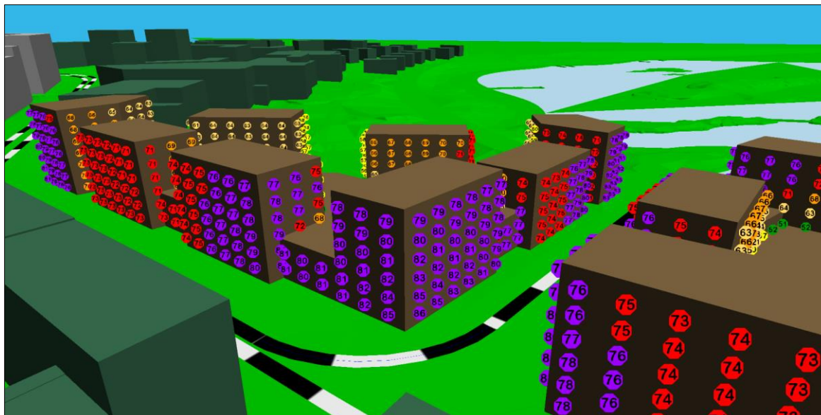
Kuva 4. Liitteen 3 mukaiset julkisivuihin kohdistuvat enimmäisäänitasot kerroksittain korttelin 49295 Haakoninlahdenkadun ja Mirandankadun risteykseen avutuilla julkisivuilla
