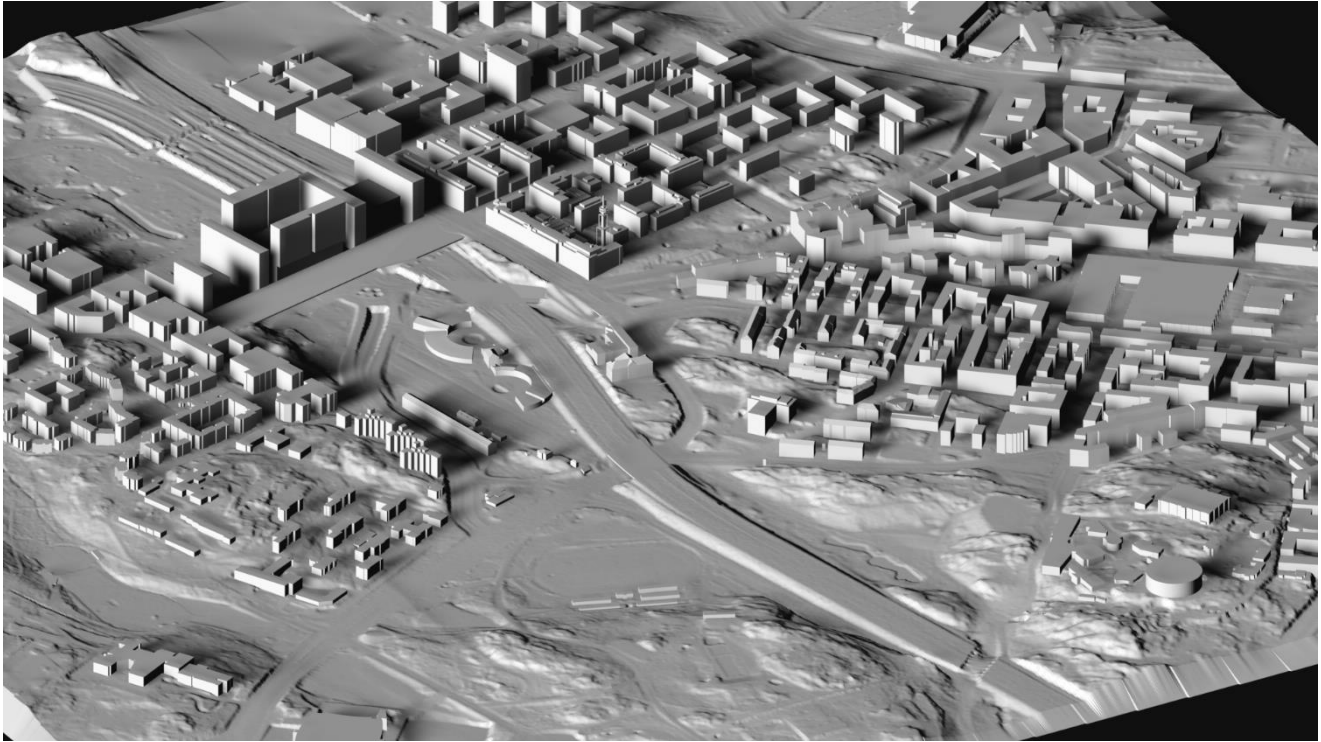
Kuva L5.1 Virtauslaskennan lähialuemalli (pintageometria näytettynä).
