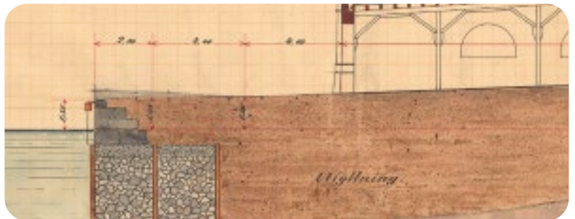
Katajanokanlaiturin rantaviiva on graniittinen pystymuuri. Tvärprofil af Skatuddskajen, n. 1900, Satamalaitoksen arkisto.
