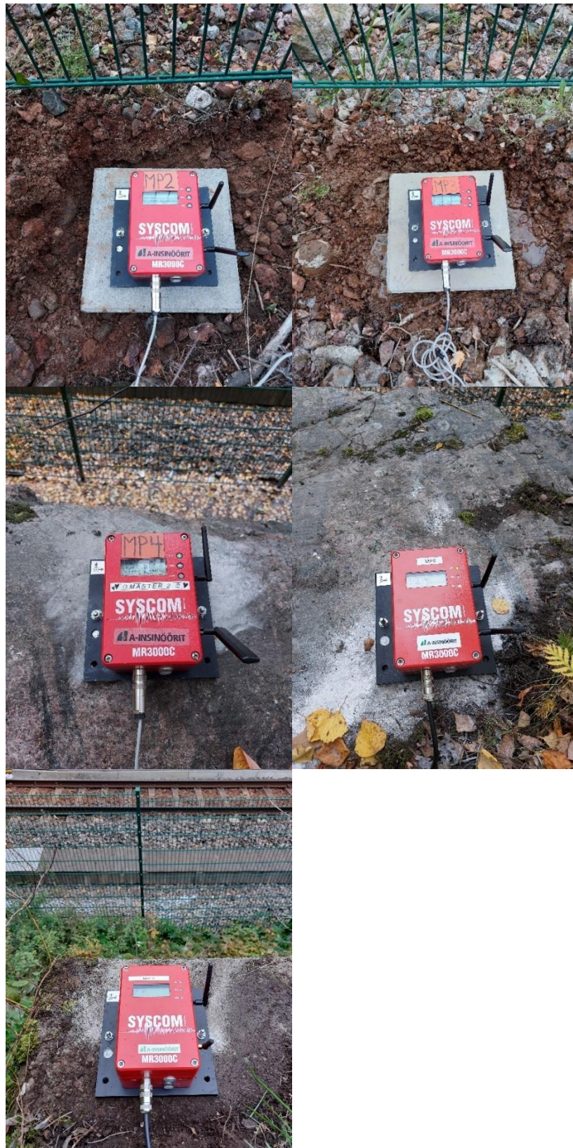
Kuva 5.2. Mittareiden asennukset. Mittarit MP1-MP4 asennettiin kiila-ankkureilla kallioon ja mittarit MP5-MP6 maanvaraisesti betonilaatoille.
