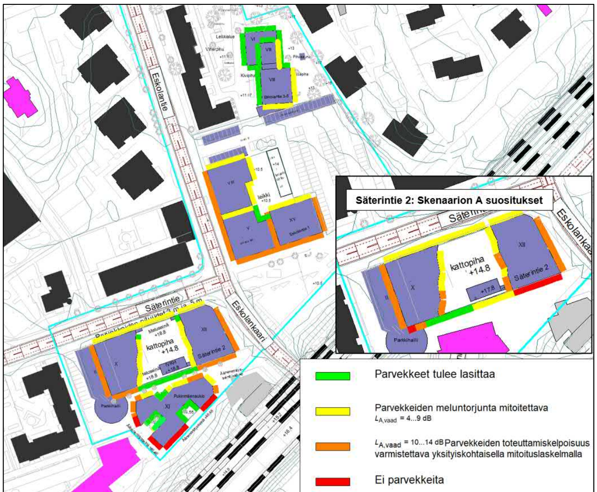
Kuva 27. Lasitettujen parvekkeiden suosituksia äänitasoero vaatimuksiksi \Delta L_{A,vaad} skenaariossa B. Kuvassa on esitetty Säterintien 2 julkisivuille muodostuvat suosituksia skenaariossa A, sillä nämä ovat mitoittavampia kun Pukimäenaukion suojaava rakennusmassa ei ole vielä toteutunut.
