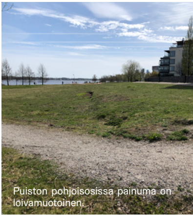
Kuvassa olevan alueen tasaus on painunut, vaikka se noudattaakin edelleen suunnitelman tasauseriaatetta.
