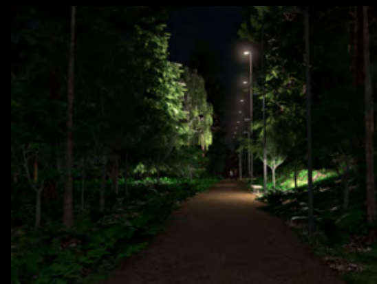
KUVA 7. KULKUVÄYLÄN HIMMEÄ VALAISU YHDISTETTYNÄ YMPÄRISTÖN YKSITYISKOHTIEN VALAISUUN
