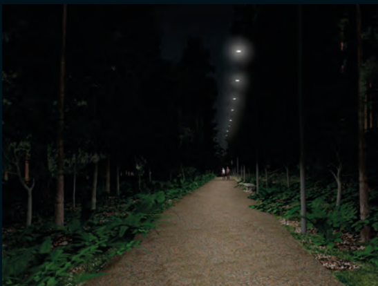
KUVA 6. VAIN PUISTOKÄYTÄVÄÄN RAJOITTUVA TASAINEN VALAISTUS NS. CUT OFF
