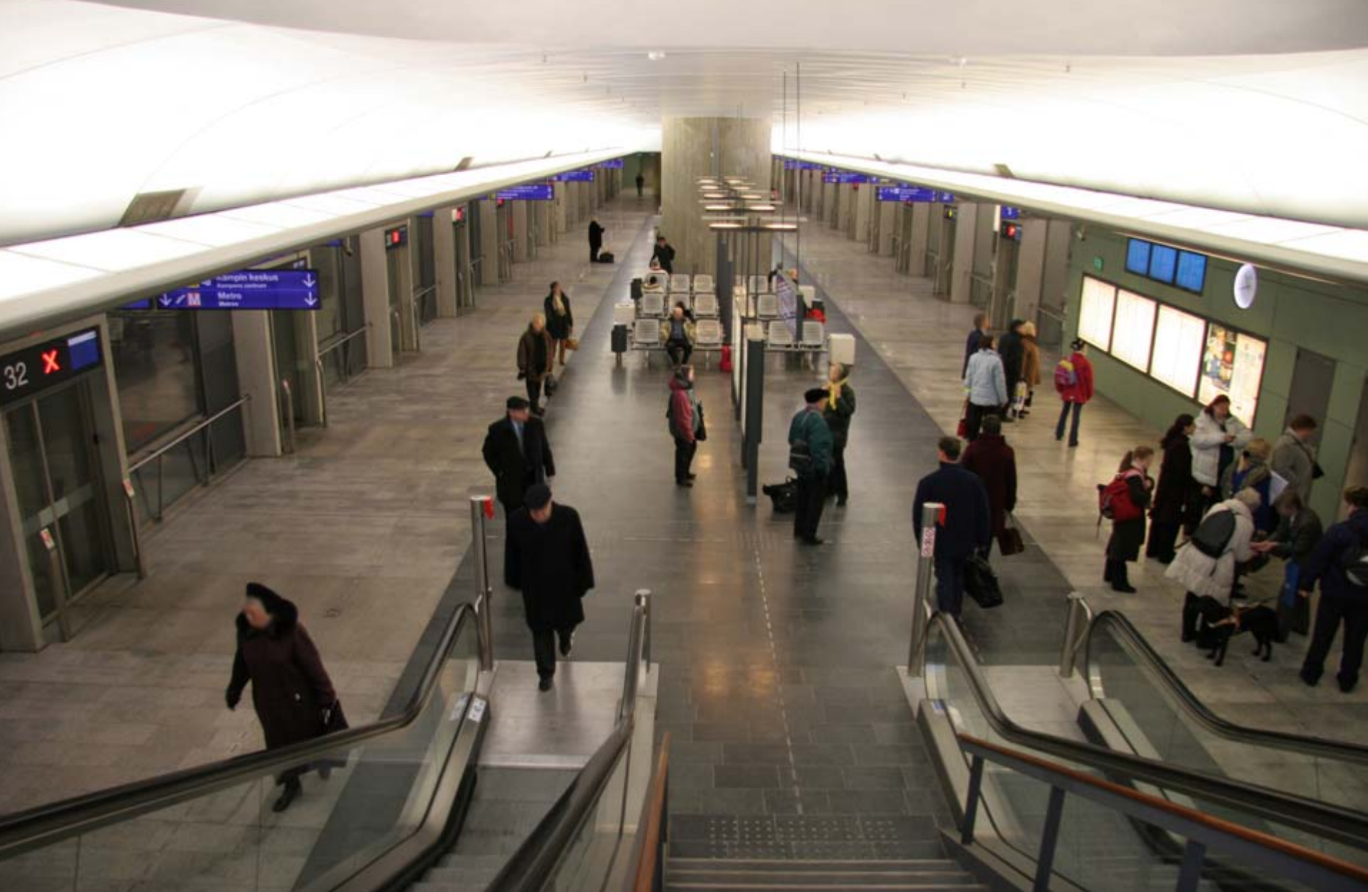
9. Epäsuora valaistus katon kautta ei aiheuta häikäisyä. (Kampin keskus)
