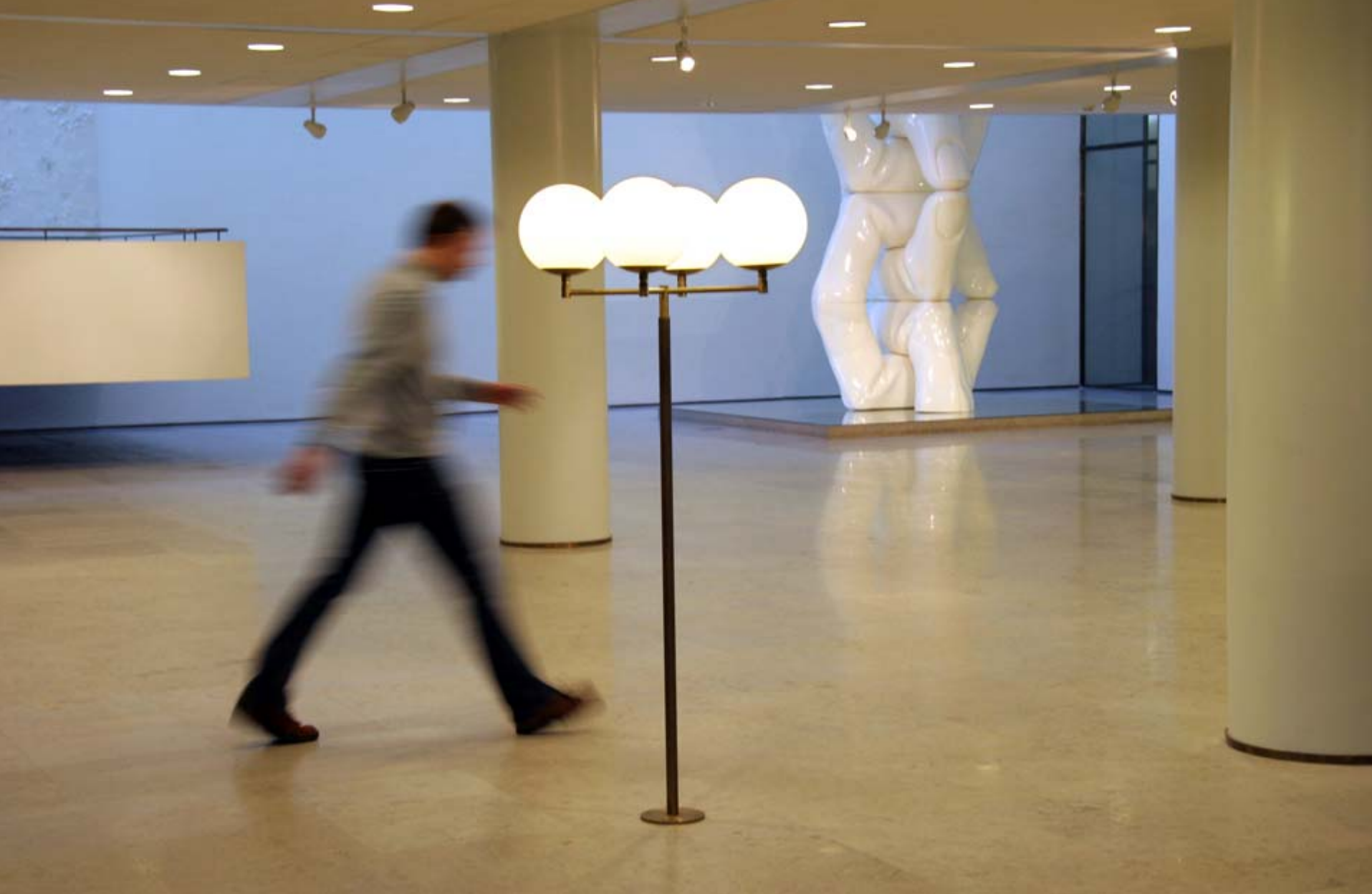
2. Pään korkeudella kulkuväylälle ulkonevat pallovalaisimet häikäisevät ja aiheuttavat törmäysvaaran. (Helsingin kaupungintalo)
