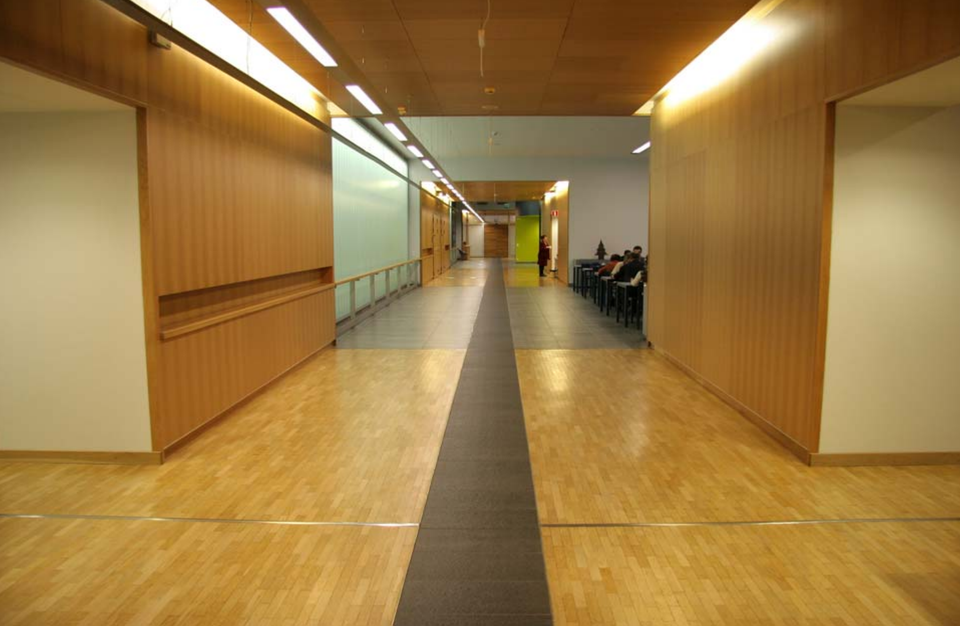
11. Käytävän katossa olevat valaisimet on sijoitettu kulkuväylän mukaisesti. Valaistus korostaa värikontrasteja. (Näkövammaisten palvelu- ja toimintakeskus Iiris)
