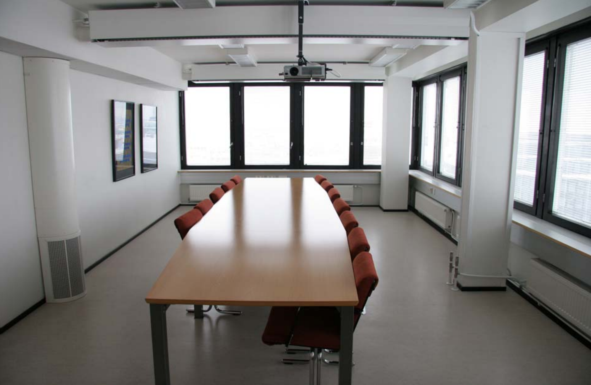
8. Ikkunat vierekkäisillä seinillä saavat aikaan miellyttävän valaistuksen, jossa ei synny vastavalohäikäisyä. (Kallion virastotalo)
