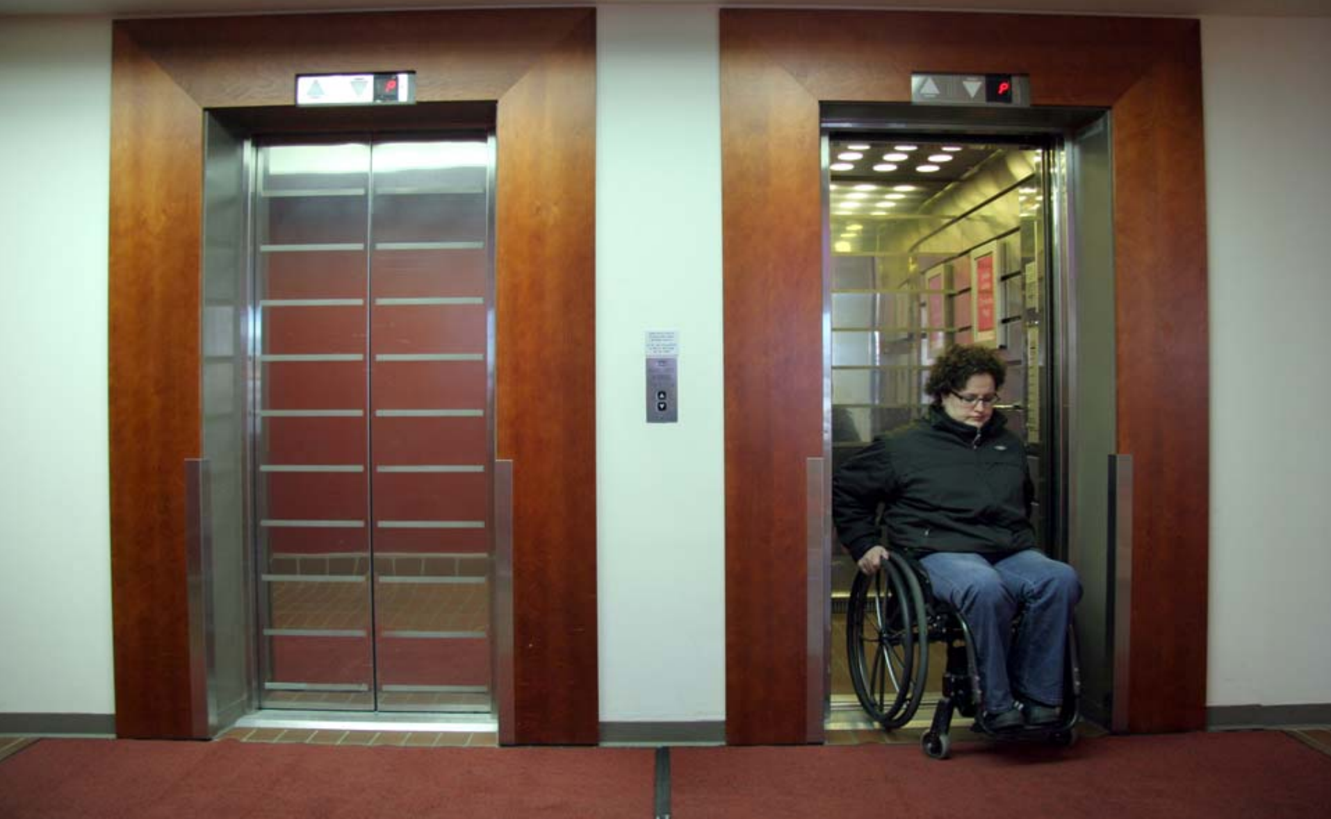
6. Hissikorin sisämitat 8 hengen standardihissillä ovat 1100 mm x 1400 mm. Ovi on lyhyellä seinällä ja sen vapaa leveys on 900 mm. Hissin ovet on helppo löytää heikon näön avulla kun ne muodostavat kontrastin ympäröivän seinän kanssa. (Radisson SAS Seaside Hotel)
