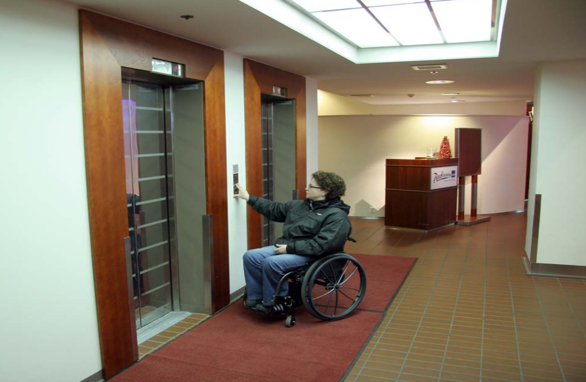
7. Vapaata tilaa tulee olla hissien oven edessä vähintään pyörätuolin kääntymiseen tarvittava 1500 mm x 1500 mm. Suositeltava tilan syvyys on puolitoista kertaa hissikorin syvyys. (Radisson SAS Seaside Hotel)
