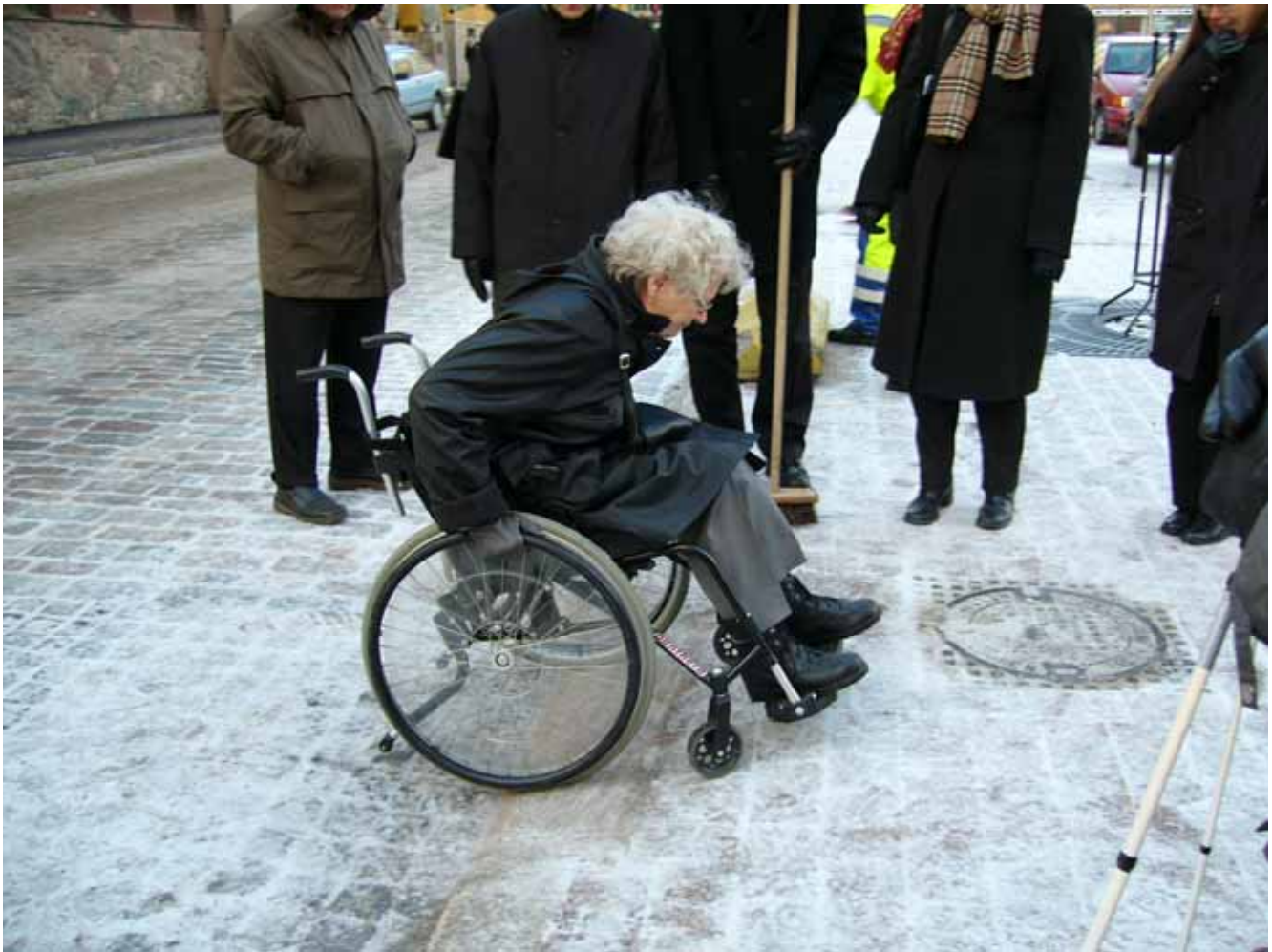
Kuva 42. Suojatien reunatukien testaus tapahtui Helsingin Kasarmitorilla osittain talvisissa olosuhteissa. Kuvassa luiskattu reunatukimalli.
