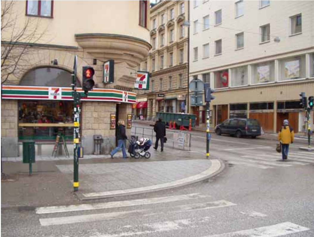
Kuva 18. Tukholman keskustassa on käytetty koko risteysalueella vaaleita pesubetonilaattoja ja suojatien reunatuen vieressä lisäksi valkoisia pesubetonilaattoja Tukholman kaupungin ohjeen mukaisesti.
