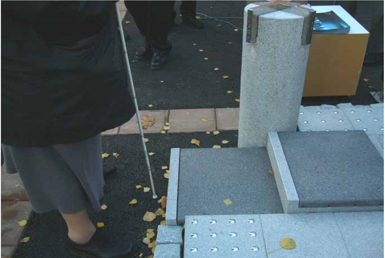
Kuva 40. Graniittikeskuksen porraselementin prototyypit saivat erittäin hyvän arvion Lasten liikennekaupungissa pidetyssä testaustilaisuudessa.
