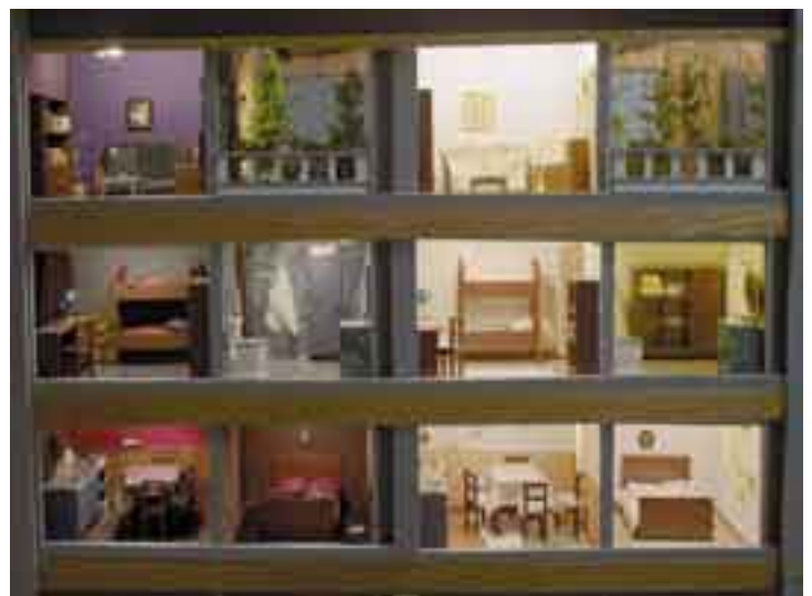
Kuva 16. Nukkekodin molemmissa "asunnoissa" on yhtä suuri valaistusvoimakkuus. Värien käyttö vaikuttaa tilojen valoisuuteen. Vaaleat värit lisäävät valoisuutta, tummat taas vähentävät sitä. (Kuva: JS)
