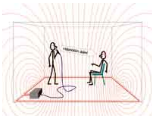
Kuva 5. Induktiosilmukan toimintaperiaate. (Kuva: JR)
