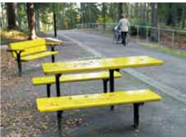
Kuva 43. Pidennetty pöytälevy mahdollistaa pääsyn pöydän ääreen myös pyörätuolin kanssa. (Suursuonpuiston vanhustenpolku, Helsinki. Kuva: AR)
