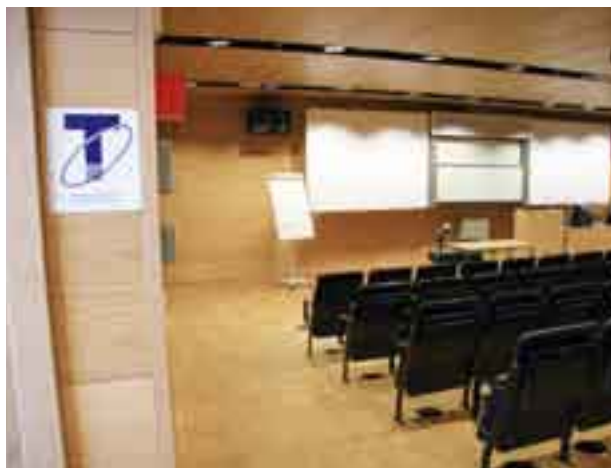
Kuva 75. Auditorion etuosaan pääsee pyörätuolilla luiskaa pitkin. Auditorion seinässä on induktiosilmukasta kertova T-opaste. (Stakes, Helsinki. Kuva: JH)
