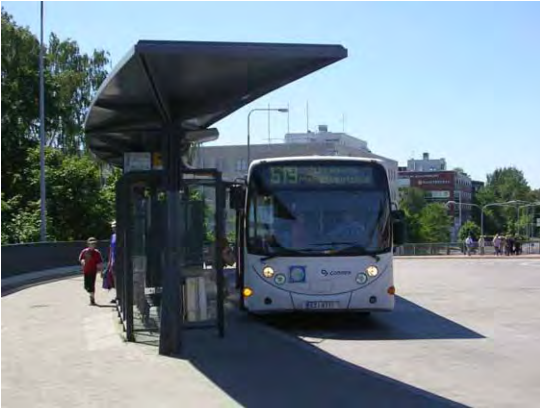
Kuva 19. Bussiterminaalien kaareva pysäkkialue tekee keskioven käytön erittäin hankalaksi. Kont-rastien puute aiheuttaa heikkonäköiselle törmäysriskin kalusteisiin ja rakenteisiin sekä putoamis-riskin pysäkkialueen reunalta. Malmin keskustan toimenpidekartan kohta 10.
