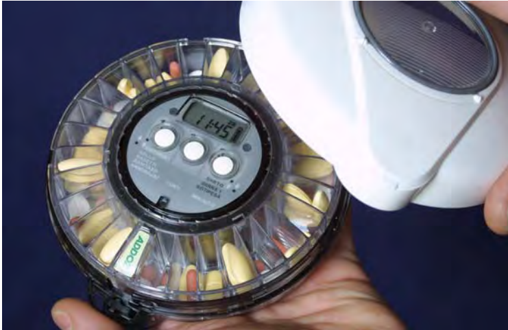
Kuva 3. Muistuttavan lääkeannostelijan sisällä oleva lääkekasetti.
