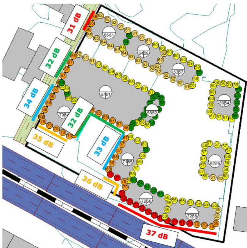
Kuva11 Suositukset ulkovaipan ääneneristävyyksille.
