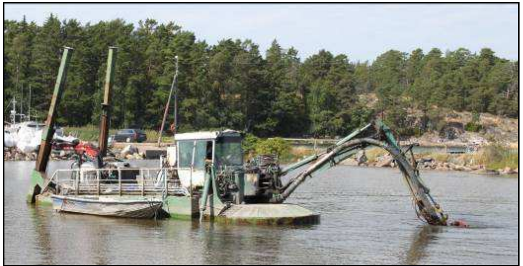
Kuva 56. Esimerkki vedessä ja maalla toimivasta monitoimiruoppaajasta eli vesimestarista (kuva: FCG)
