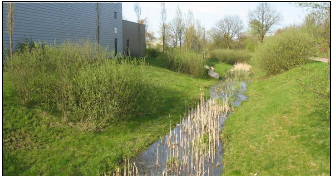
Kuva 39. Hulevesien viivytyspainanne on sijoitettu tonttien reunaan. 7
