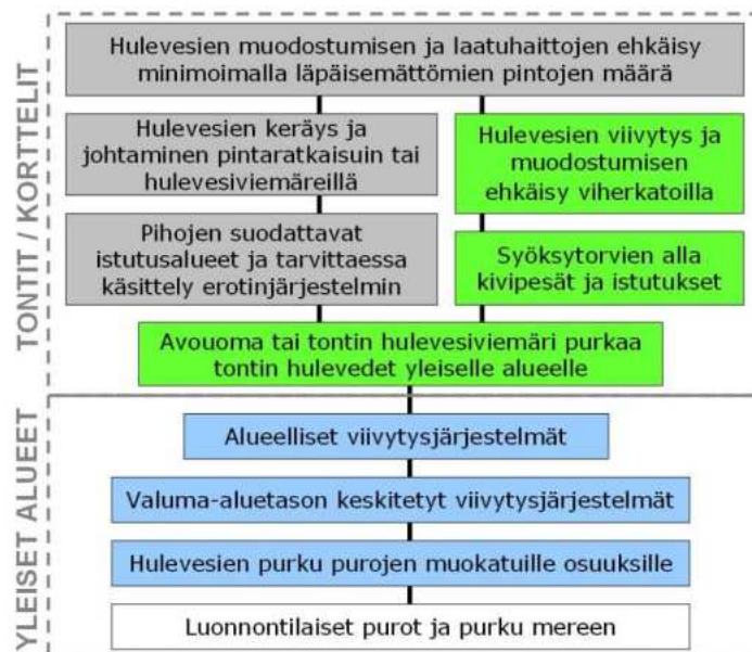
Kuva 21. Suositellun hulevesien hallintaketjun vaiheet. 7
