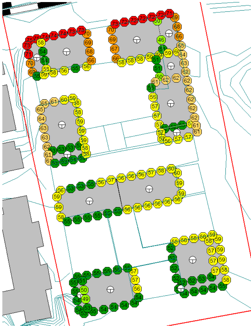
Kuva 7 Raitiotien aiheuttamat enimmäisäänitasot julkisivuilla.
