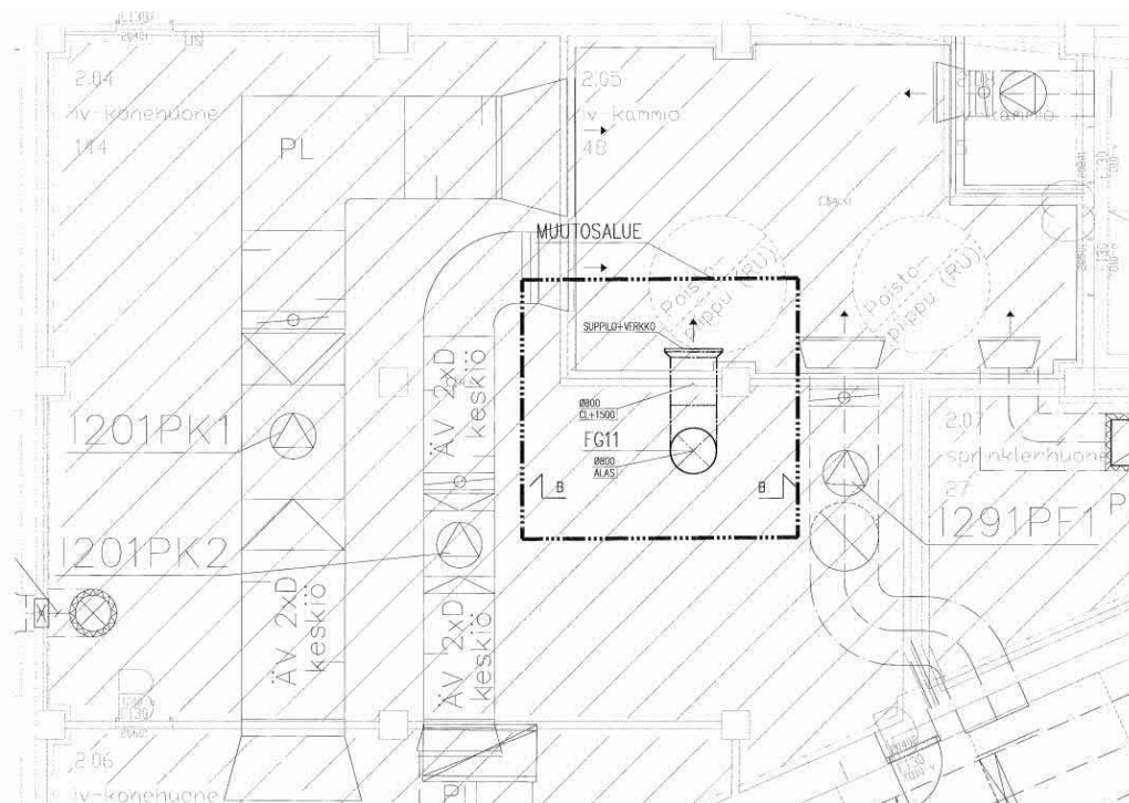
Kuva IV-1: Taso +10,20, jossa sijaitsevat mm kojeet I201PK1, I201PK2, I291PF1 ja I291PF4
