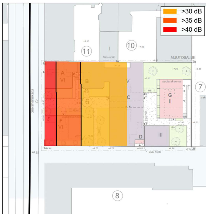
Kuva 4: Runkomelumallinnuksen tulos Snellmaninkadulla kulkevalle raitiotieliikenteelle, esitettynä asemapiirroksessa rakennusten 1. kerroksen osalta. Kuvassa on esitetty alueet, joissa runkomelu ylittää mallinnuksen perusteella 30 dB runkomelutason.
