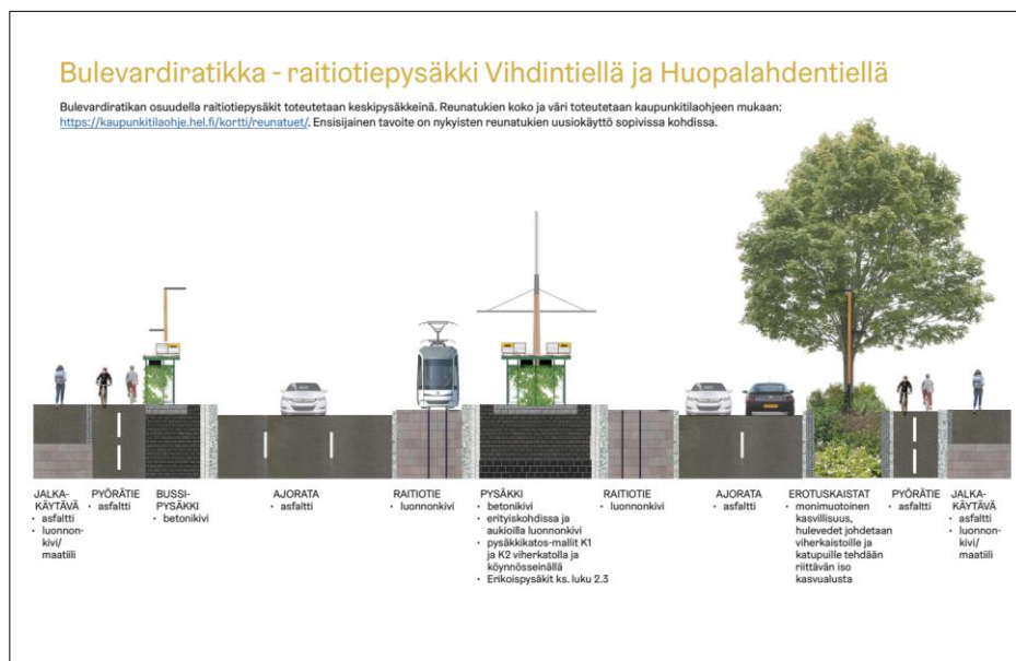
Huopalahdentiellä raitiotiepysäkit toteutetaan keskipysäkkeinä. Länsi-Helsingin raitioteiden Design Manual. WSP 2022.
