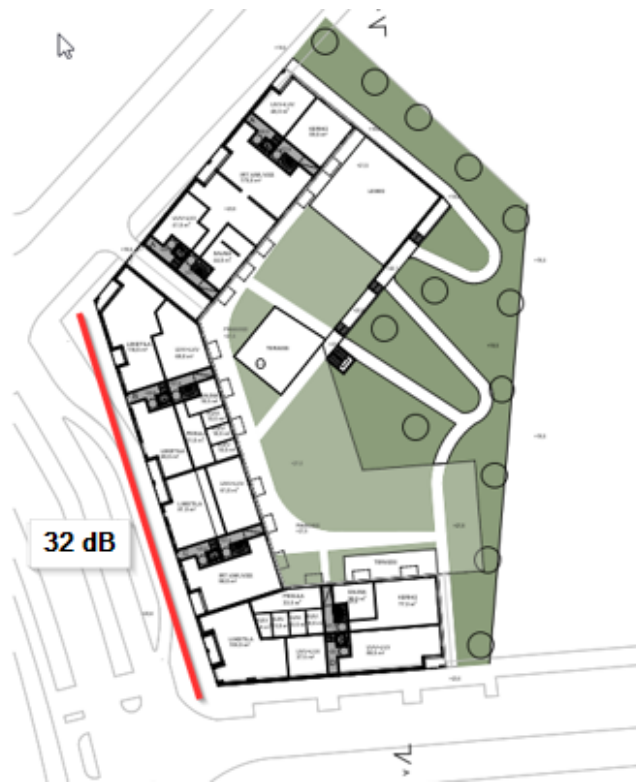
Kuva 2. Kuvassa on esitetty tie- ja raitioliikenteestä keskiäänitasoista rakennuksen julkisivuille muodostuvat 30 dB tai sen ylittävät ulkovaipan äänitasoero-vaatimukset \Delta L_{A,vaad} .
