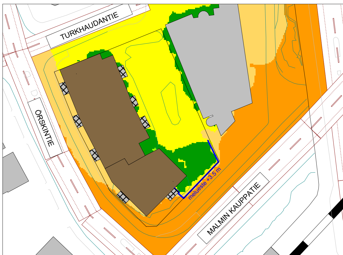
Kuva 2. Meluesteen sijoitus ja vaikutus pihalla esiintyviin keskiäänitasoihin.
