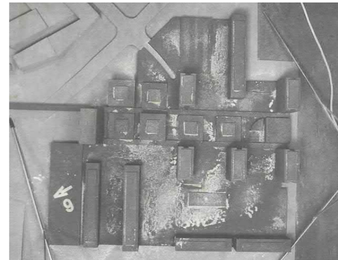
Savun kulkeutumista Hanasaaren voimalasta Merihakaan testattiin tuulitunnelissa. Sulo Savolaisen arkisto.
