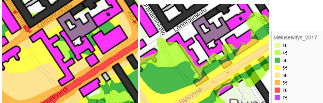
Kuva 3. Vasemmalla katuliikenteen päivääjan keskiäänitaso L_{Aeq7-22} laskentakorkeudella mp+2m , oikealla raitiotieliikenteen vastaava keskiäänitaso L_{Aeq7-22} .
