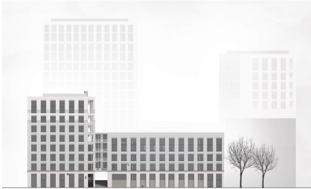
1. PAIKALLAMUURATTU TIILI, KOLME ERI SÄVYÄ 2. PYSTYTILI 3. JULKISIVULASI 4. KAIDELASI 5. SYVÄ PYSTYURITETTU MUOTTIBETONI, LASUURI KÄSITTELY 6. KERROSLISTA BETONI 7. METALLIKAIDE 8. PUUMETALLISALEIKKO 9. KOLMIOMUOTOINEN PUURIMA 10. STOFIX-TIILIAATTA, KOLME ERI SÄVYÄ 11. PARVEKELASITUS, 12. PARVEKKEEN TAUSTA SEINÄ, MAALATTU BETONI TIILEN SÄVYYN
