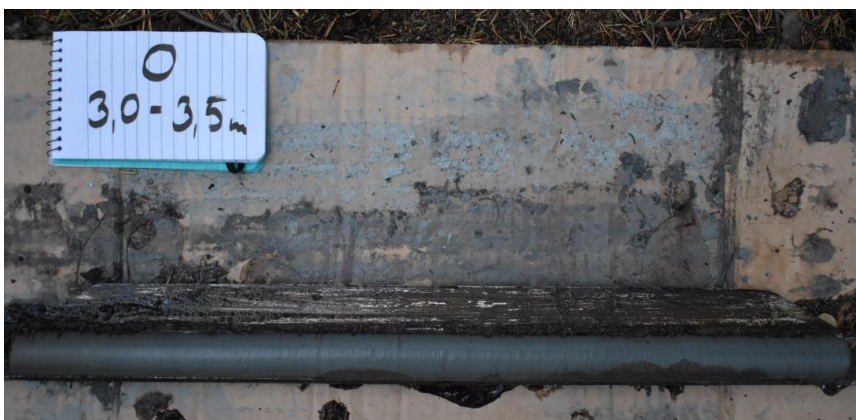
Kuva 6. Tutkimuspisteessä O syvyydellä 3,0... 3,5 m mitattiin inkuboinnin jälkeinen pH 3,2.
