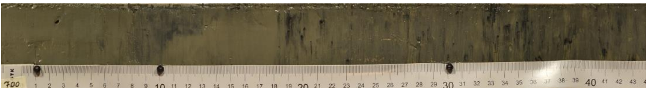
Kuva 9. Tutkimuspisteessä 3 syvyydellä 7,0... 7,4 m esiintyy tummia sulfidiraitoja.
