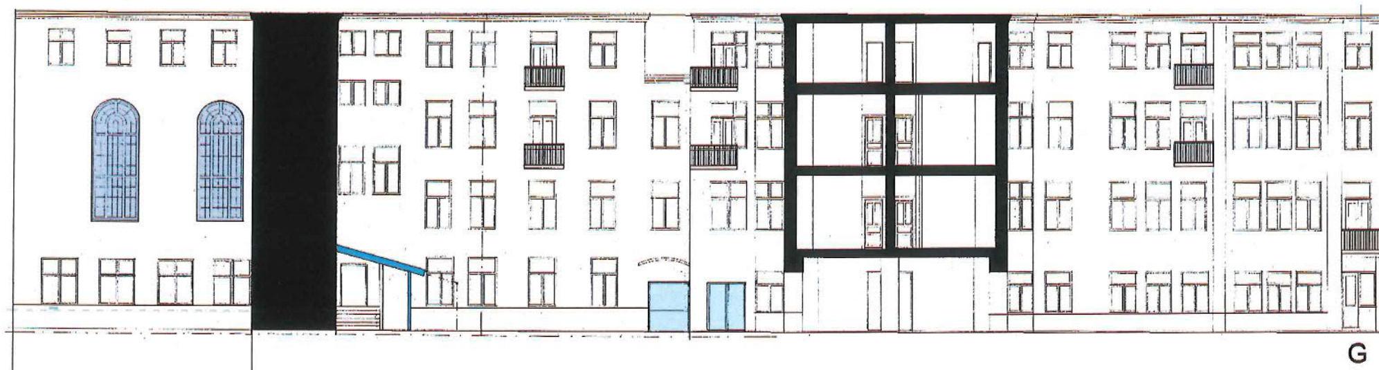
Pihajulkisivu etelään vuodelta 2013. Pihajulkisivun rappauspinnat, toimistohuoneiden ikkunat sekä kaikki parvekkeet uusittu O.
