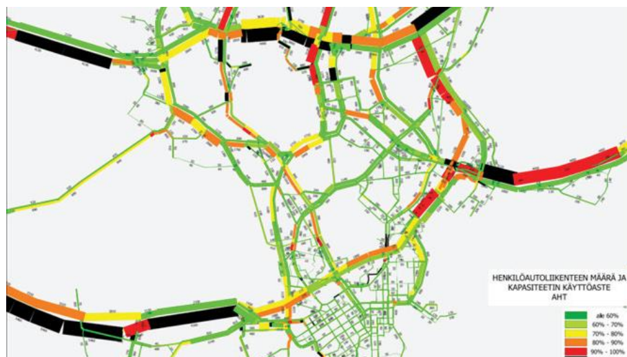
Kuva 71. Vuoden 2035 skenaario autoliikennemääristä kantakaupungin katuverkolla kun keskustatunneli on rakennettu. Tunnelilla on vaikutusta keskustan katujen ruuhkaisuuteen, mutta ei helpota sisääntuloväylien ruuhkaisuutta. Lähde: KSV / Helsingin kantakaupungin autoliikenteen skenaariot (2013)
