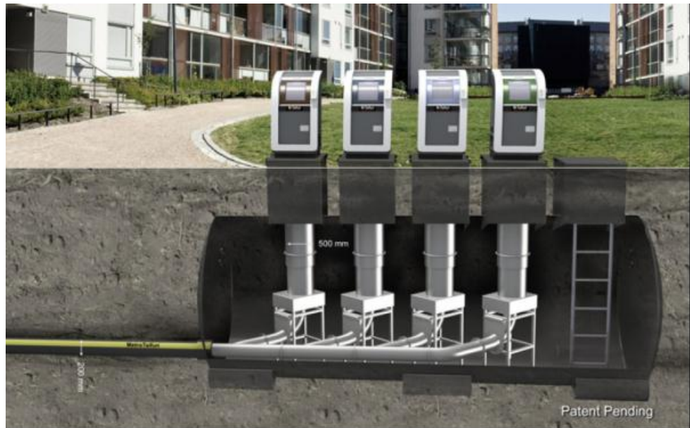
Kuva 18 Jätteen putkikeräyksen syöttöputket ja säiliöt Tampereen Vuoreksen alueella (Lähde: Pirkanmaan Jätehuolto Oy).
