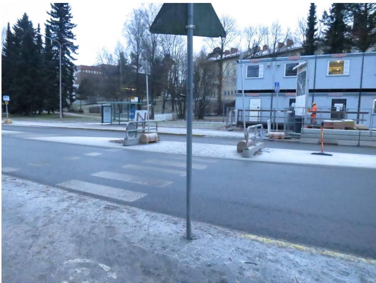
Kuva 19. Korkeat ja raskastekoiset kaide-elementit heikentävät näkyvyyttä ja voivat vaikeuttaa lapsen havaitsemista suojatiellä. Suojatien väliaikaiset liikennejärjestelyt olisi hyvä korvata kiinteällä keskisaarekkeella.
