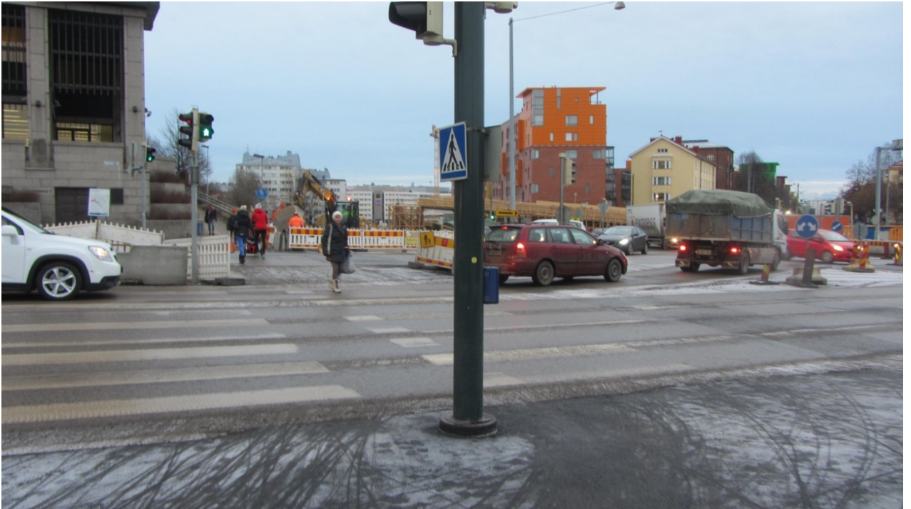
Kuva 7. Suojatien havaittavuutta heikentää se, etteivät ajoratamaalaukset sijaitse suojatien kohdalla. Korkeat ja umpinaiset työmaa-aidat voivat estää autoilijaa havaitse- masta pientä lasta.
