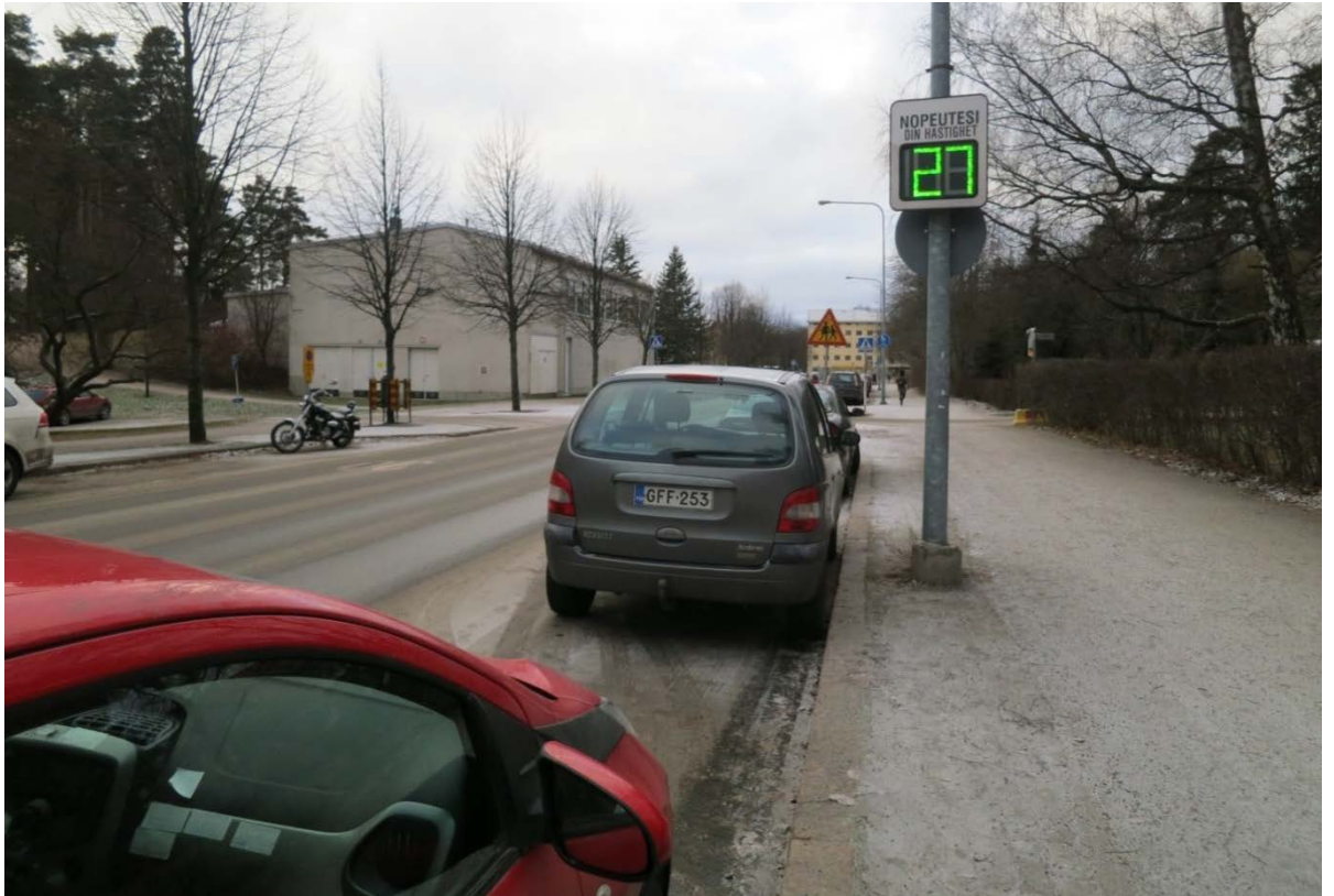
Kuva 17. Pohjolankadulla on käytössä nopeusnäyttötäulu. Nopeusnäyttötäuluja on hyvä hyödyntää ajonopeuksien hillitsemisessä, ja taulujen keräämää tietoa kannattaa hyödyntää viestinnässä, liikennesuunnittelussa sekä mahdollisen liikennevalvonnan ajoittamisessa.
