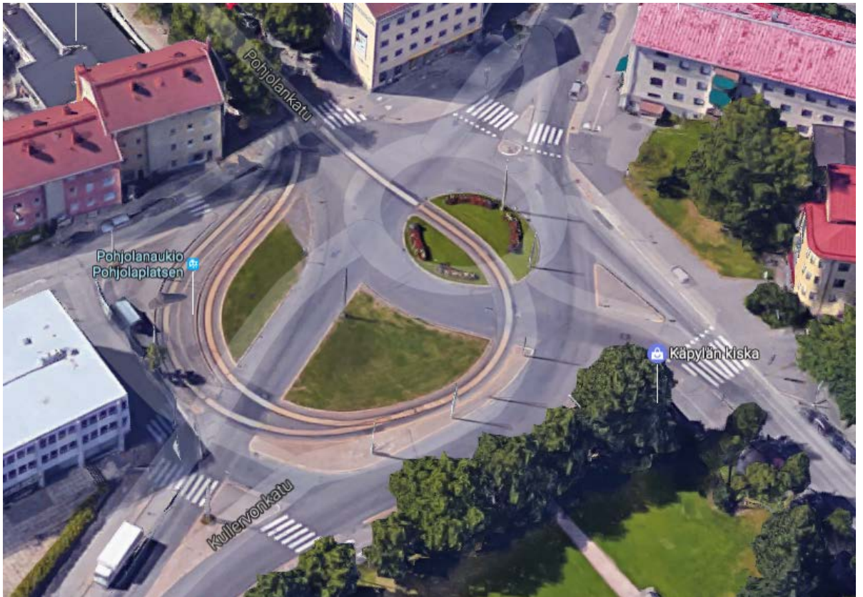
Kuva 21. Epäselvä ja laaja liittymä on erityisesti vieraammalle kuljettajalle hankalasti hahmotettava, jolloin kuljettajan huomiokyky kärsii. (Kuva: Google Maps.)
