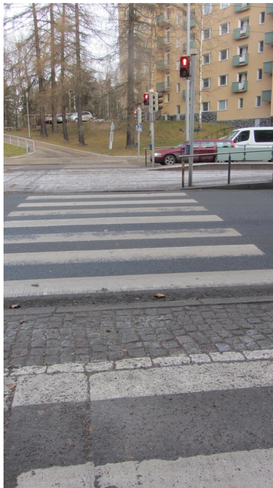
Kuva 14. Suojatiesaarekkeet ovat kapeat, eikä isompi ryhmä mahdu odottamaan valon vaihtumista.
