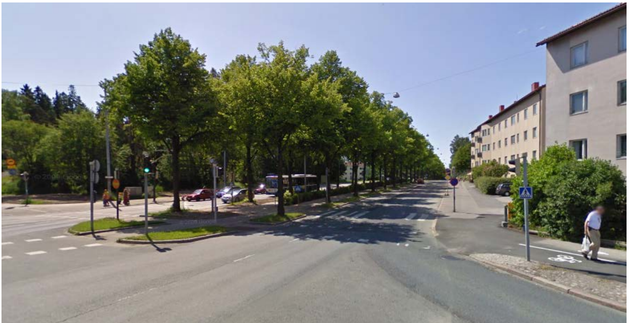
Kuva 20. Koskelantien ylittävä suojatie on vaikeasti havaittavissa. (Kuva: Google Maps.)
