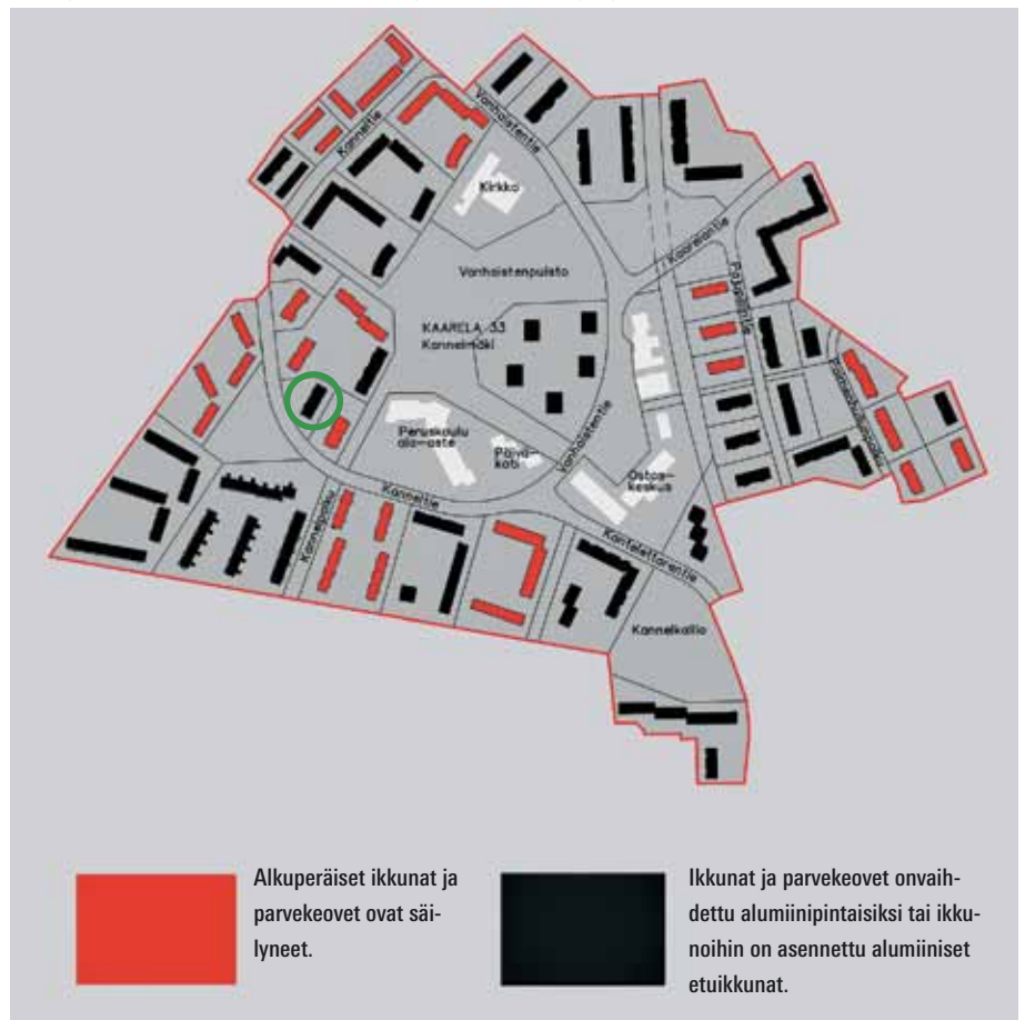
Noin puolet Kannelmäen puuikkunoista ja ikkunaovista on vaihdettu puu-alumiini-ikkunoiksi ja -parvekeoviksi. Ympyrällä merkityn As Oy Kannentie 5:n ikkunat ja parvekeovet on uusittu puurakenteisina.
