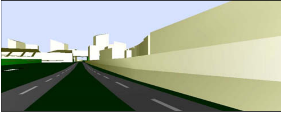
Kuva 5.25e: Näkymä Veturitien puolelta. Veturitien korkeusasema laskettu, este 4 m sekä sisäänvedetty talo. Kuva tuntuu antavan vaikutelman, että sisäänvedetynkin talon ja esteen väliin jää ahdas kuilu.
