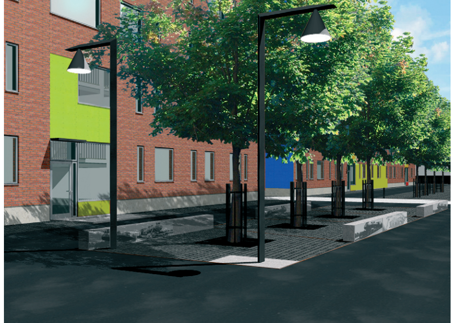
Puut istutetaan suurikokoisina. Puiden suojana toimivat valurautaiset juurisuojat, teräksiset runkosuojat.
