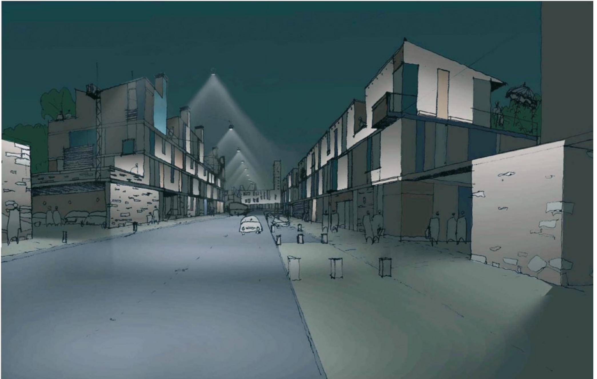
HAVAINNEKUVA: RAKENNUSTEN SEINIIN KIINNITETTÄVÄT RIPUSTETUT AJOKATUJEN VALAISIMET (VALAISINTYYPPIESIMERKKI C)
