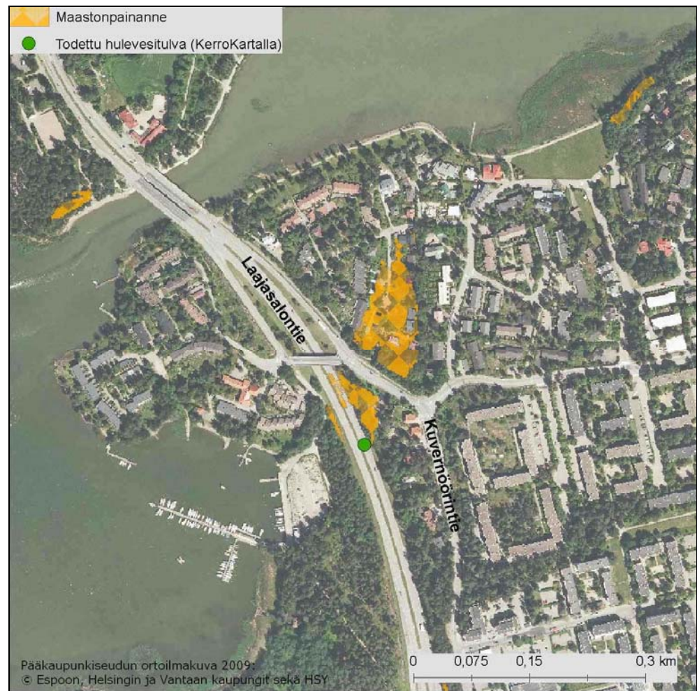
Kuva 58. Laajasalontieellä havaittu toistuva hulevesitulva
