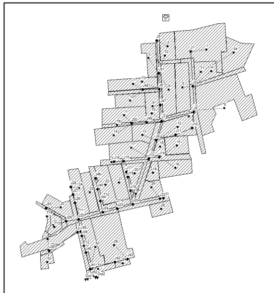
Kuva 20. Esimerkki SWMM:n tarkastelu- aluenäkymästä. Kuvassa nähtävissä alueen jako osavaluma-alueisiin sekä viemäriverkosto sol- mukohtineen
