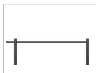
A7 HKR istutusten suoja-aita, putki
