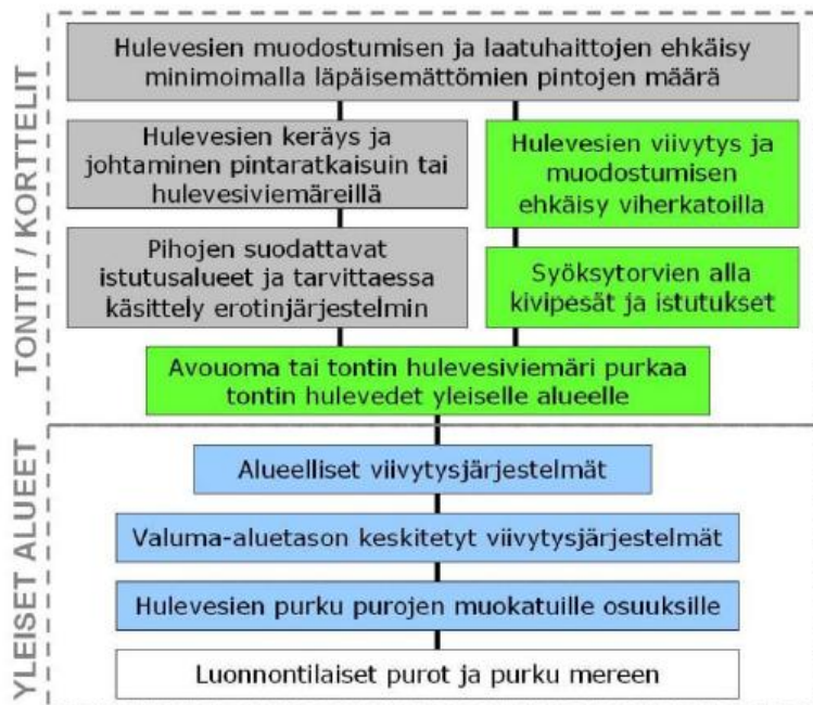
Kuva 21. Suositellun hulevesien hallintaketjun vaiheet. 7
