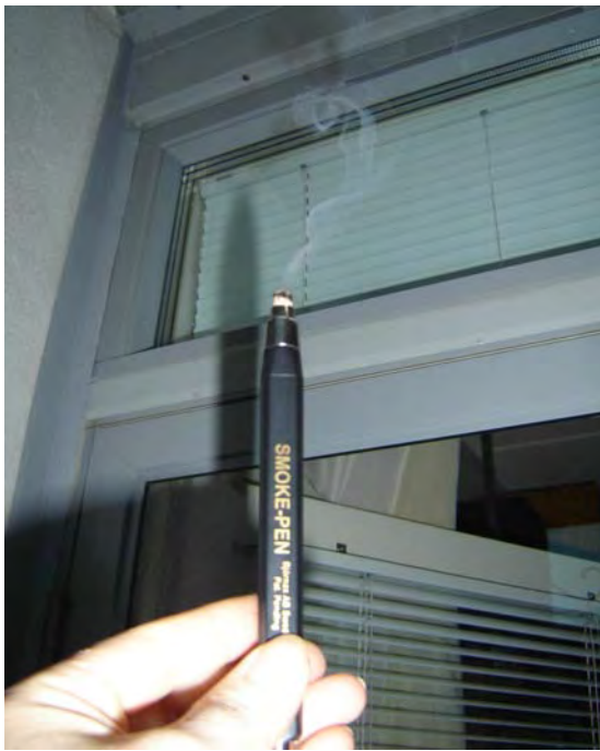
Savukynä on oivallinen apuväline ilmavirtausten mittaamisessa.
